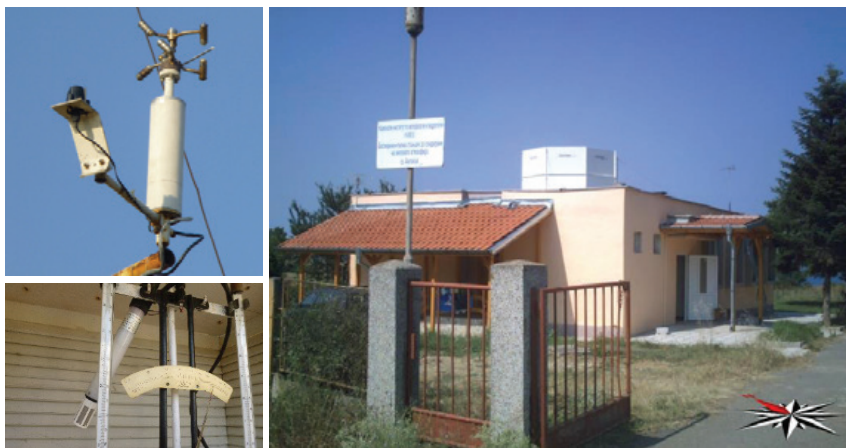
Фиг. 3. Налична апаратура: тримерен акустичен анемометър (горе ляво), сензор за температура и влажност на атмосферния въздух (долу ляво), Содарна система върху покрива на административната сграда на МО Ахтопол (дясно)
