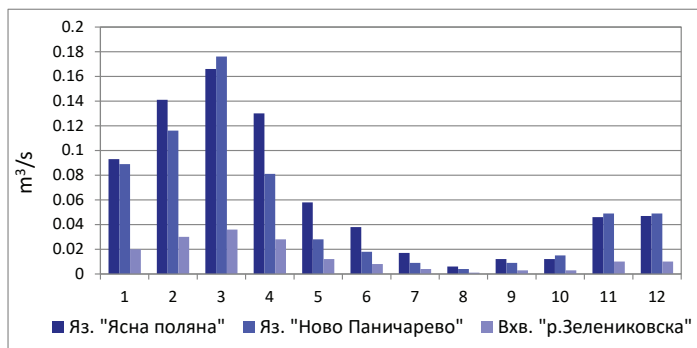
Fig. 6. Minimum acceptable runoff for „Yasna polyana“ WRS according to option 1 Фиг. 6. Минимално допустим отток за ВС „Ясна поляна“ по вариант 1
