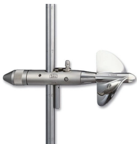
Фиг. 1. Хидрометрично витло с перка Ø 80mm Fig. 1. Hydrometric propeller with a blade Ø 80mm
