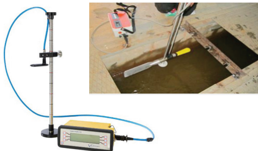
Фиг. 2. Магнитно индукционно витло Fig. 2. Magnetic induction propeller
