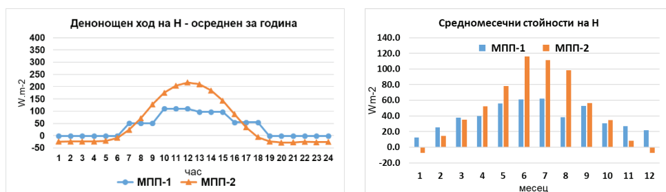
Фиг.2. Денонощен ход на потока топлина H , осреднен за 2022г. (вляво) и средномесечни стойности на потока топлина H за 2022 г. (вдясно), според МПП-1 и МПП-2
