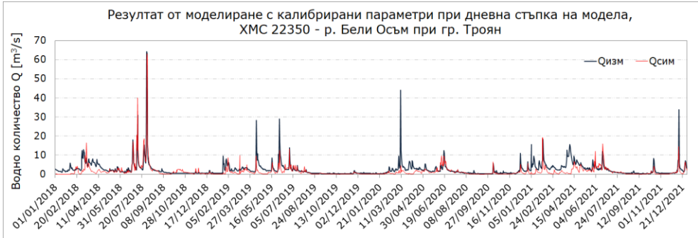
Фиг. 9. Резултат от симулиране на водното количество при ХМС 22350 – р. Бели Осъм при гр. Троян
